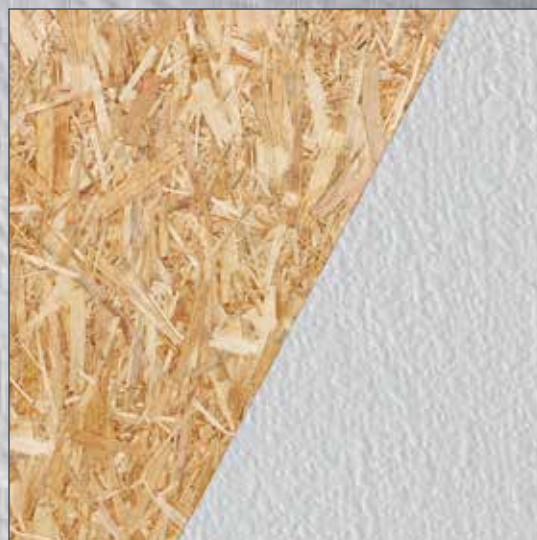
Płyty OSB: nałożyć podkład gruntujący i następnie wytapetować.
